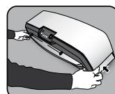
La plastificadora Titan™ tiene soportes de desplazamiento integrados para un movimiento fácil y seguro. Empuje hacia adentro las solapas en ambos extremos de la plastificadora para acceder a ellos.
