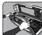
Pour ouvrir le mécanisme à courroie, tirer les deux leviers à came, des deux côtés du mécanisme, vers l'avant. Le chariot supérieur peut maintenant être soulevé à partir du devant. Soulever le chariot et l'ouvrir entièrement jusqu'à ce qui soit en position couché.
