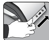
Para abrir la tapa superior, mueva las palancas de cada lado de la máquina hacia atrás para liberar el cierre de seguridad electrónico.
