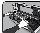
Para abrir el mecanismo de la correa de transmisión, tire de las 2 palancas de leva hacia adelante, en ambos lados del mecanismo. El carro de corte superior ahora puede levantarse hacia arriba desde la parte delantera. Levante el carro de corte y abra totalmente hasta que se detenga en la posición de descanso.
