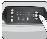
Seleccione la configuración 'abrir' ( ) con los botones de navegación en el panel de control. Presione el botón 'OK'.
