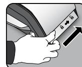
Pour ouvrir le couvercle supérieur, pousser les leviers de chaque côté de l'appareil vers l'arrière pour dégager le verrou de sécurité électronique.
