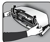
Soulever le couvercle supérieur avec les deux mains. Le moteur de plastification et le mécanisme à courroie seront visibles.
